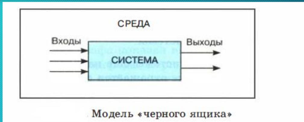
Вход системы - это воздействие на систему со стороны внешней среды, а выход - это воздействие, оказываемое системой на окружающую среду. В такой модели внутреннее устройство системы скрыто.
